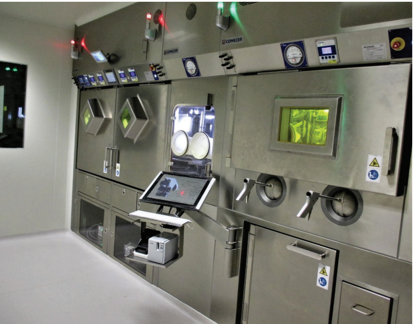
Слика 1. Лабораторија за производство со инсталирани оловни кабинети за синтеза и делење на дози
