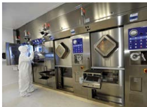
Слика 3. Заштитни оловни кабинети за производство на 18Флуоро-2-деокси-гликоза (18F-FDG),
